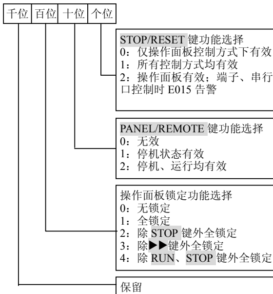
图5-58 操作面板按键功能及锁定选择设定
